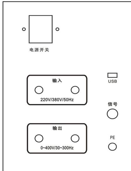
图1-2 侧面接线图
