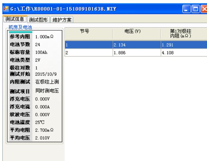
图 5.4 电池组设置参数及测试数据
