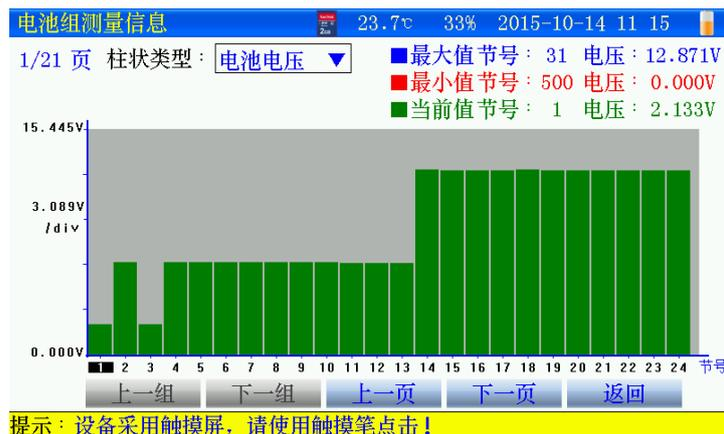
图 4.5.4-1 电池组柱状图界面
