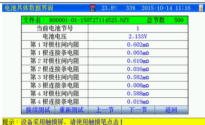
图 4.5.4-2 每节电池详细测试数据界面
