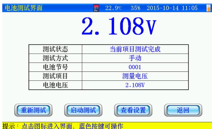
图 4.3.1-1 仅测量电压界面
