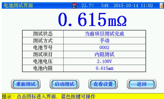
图 4.3.1 在极柱上同时测量电压和内阻测试界面
