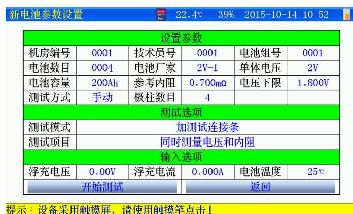
图 4.2.1-1 新电池参数设置界面
