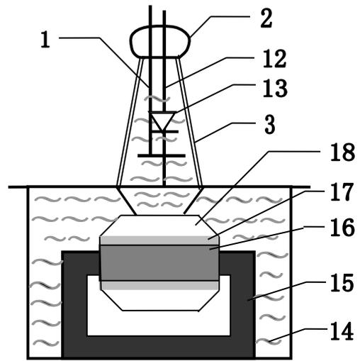
图 2: 单台油浸式试验变压器内部结构图
