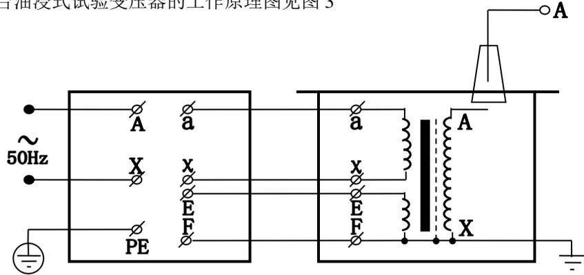
图 3：单台 YDJ 油浸式试验变压器原理图
