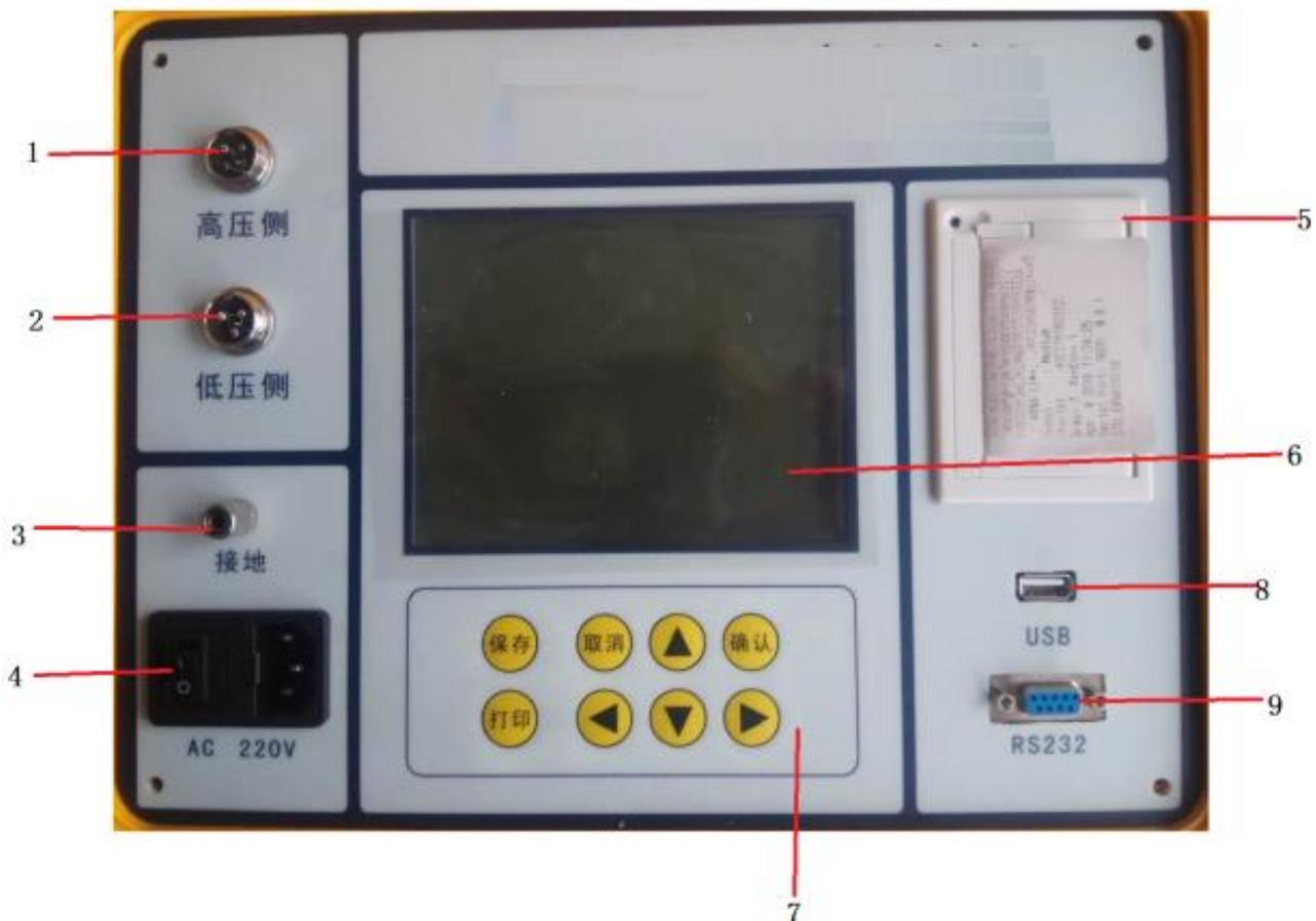
1. 高压侧 对应接被测变压器高电压侧的 A、B、C 三相。
