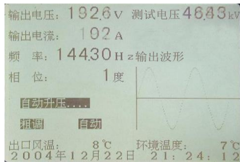
图 28 HMCXZW 变频电源装置自动升压过程
